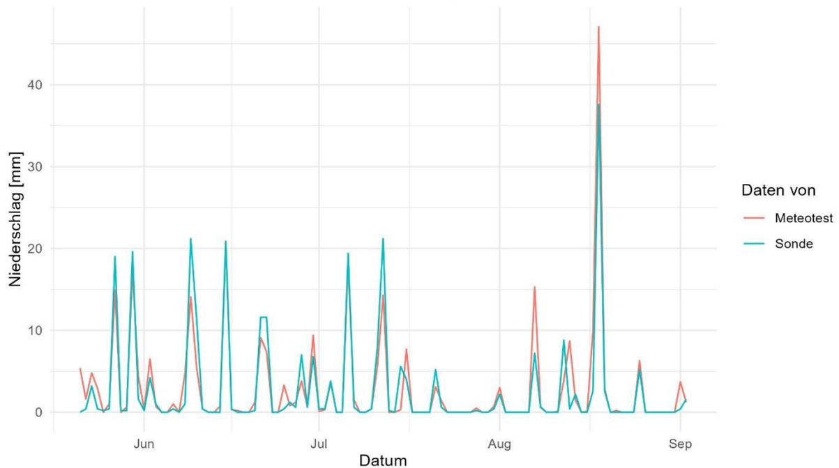
Meteotest (blaue Linie) misst nur den Niederschlag. Der Regenmesser der Sonde (rote Linie) misst Niederschlag UND Bewässerung.
