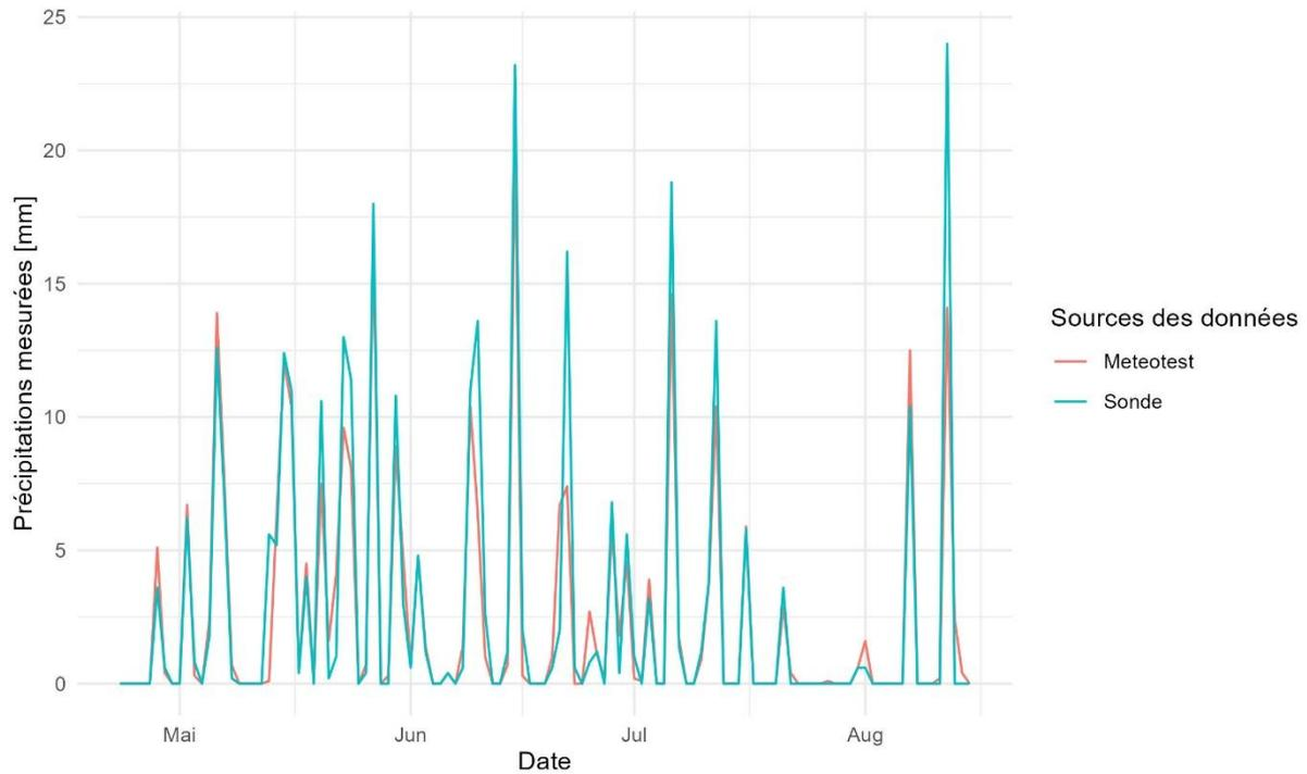
Meteotest (ligne bleue) ne mesure que les précipitations. Le pluviomètre de la sonde (ligne rouge) mesure l'addition des précipitations et de l'irrigation.
