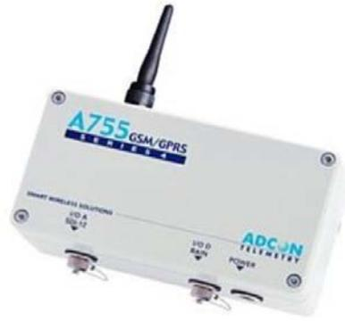
Adcon A755, Datenlogger mit integriertem Mobilfunkmodem
