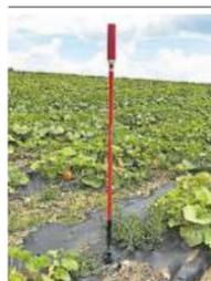
**Feuchtesensor in einem Kürbisfeld. Hier wurde die Elektronik auf der Spitze einer Slalomstange montiert, um eine bessere Funkverbindung zum Bewässerungscomputer zu ermöglichen.**
