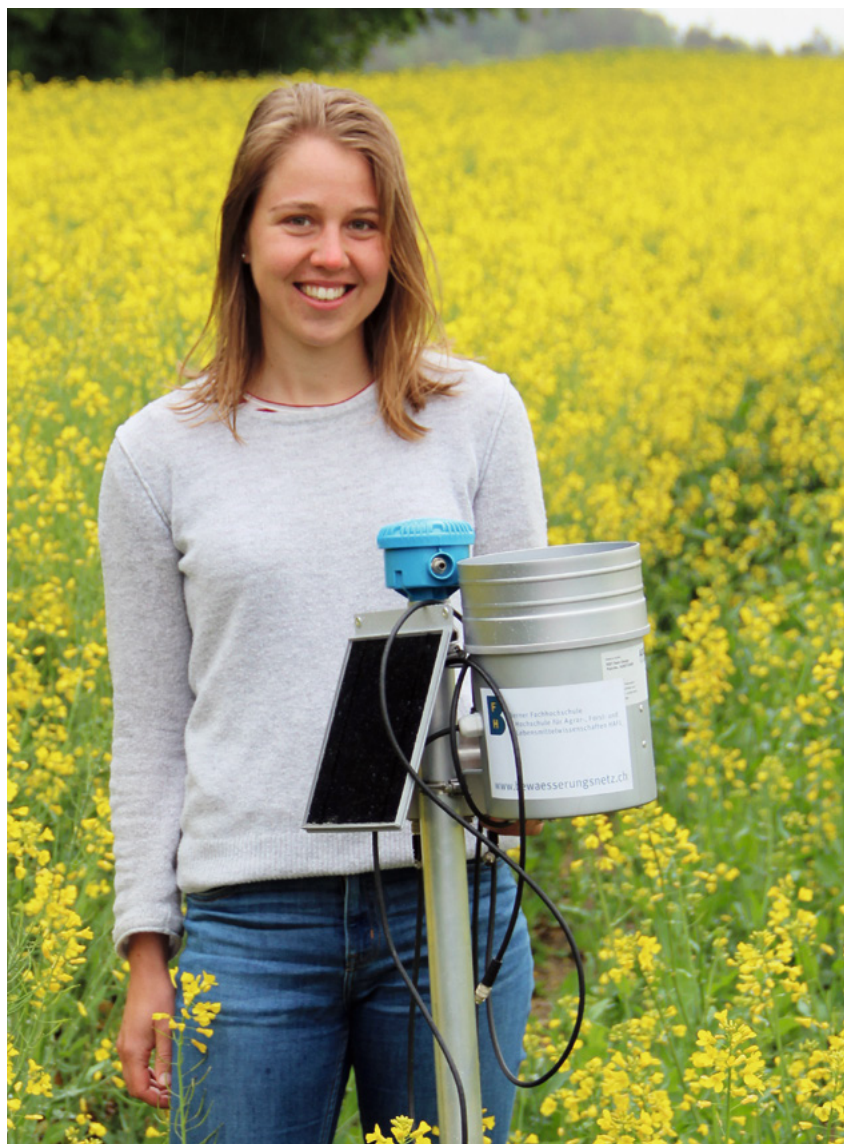
Andrea Marti, wissenschaftliche Mitarbeiterin im Team von Andreas Keiser an der HAFL, mit einer Bodenstation zur Messung der Bodenfeuchtigkeit.
