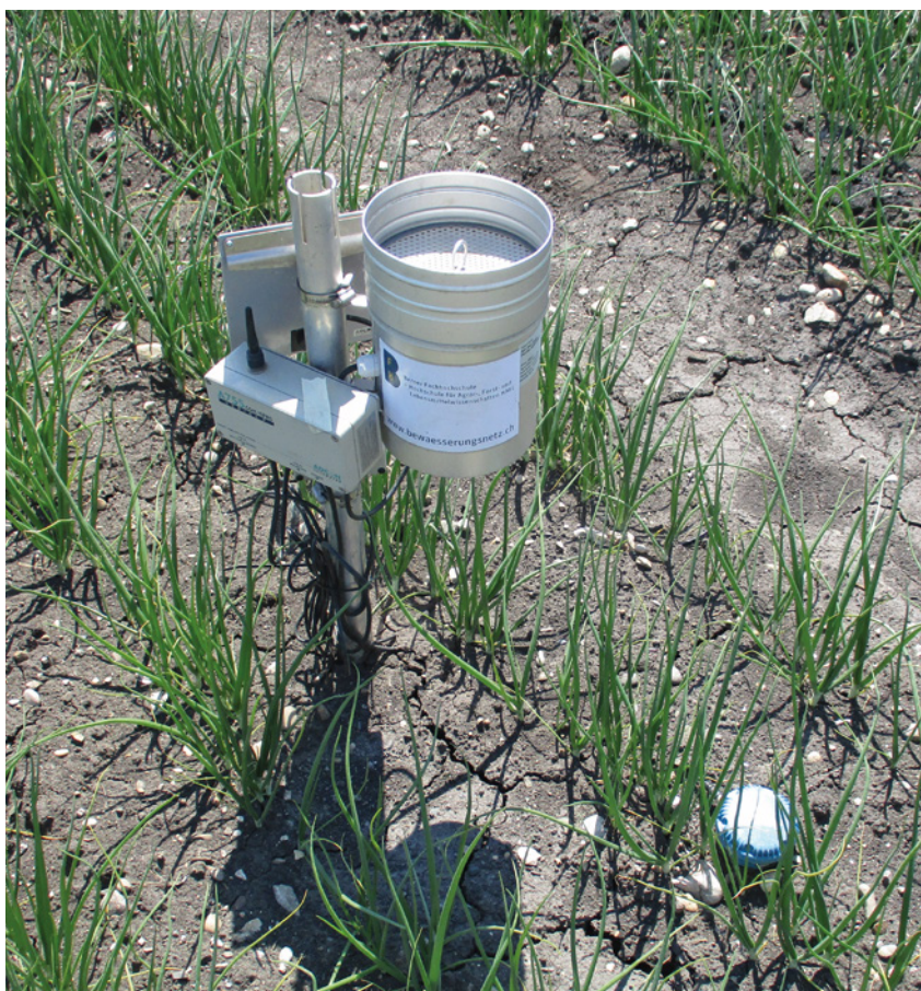
Mittels Bodensonden wurden die Ergebnisse der Bilanz-Methode validiert. Die Übereinstimmung war grundsätzlich gut.
