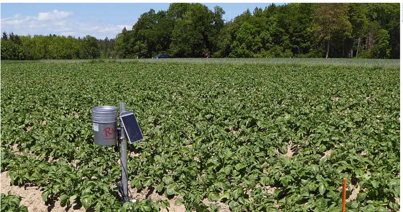
Liefert Entscheidungshilfe für die Bewässerung: Bodensonde in Kartoffelfeld. | Elle facilite la prise de décision : sonde dans un champ de pommes de terre.
